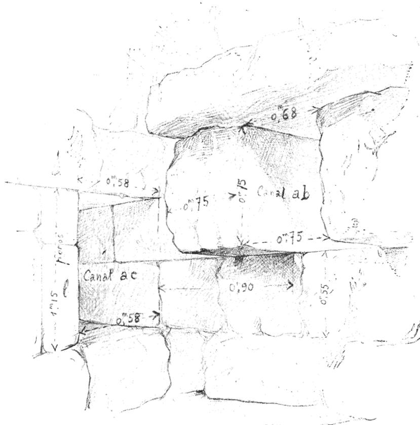
Fig. 136. — Croquis montrant la communication intérieure des aqueducs a c et a b.
